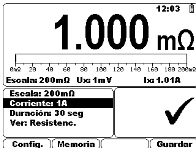
Figura 4.16: Vista de resistencia
