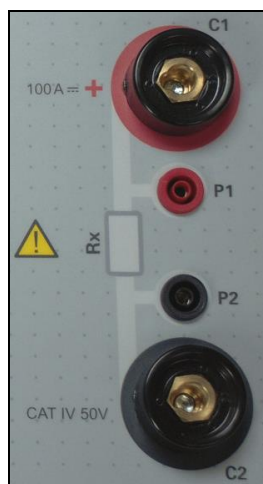
Figura 4.2: Terminales de corriente y de tensión del MicroOhm
