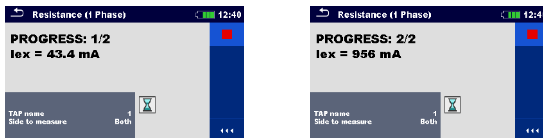
Figura 11.17: El indicador de progreso en la medición de la resistencia del bobinado de un transformador monofásico: Prueba de lado H en curso (izquierda), lado X en curso (izquierda)
