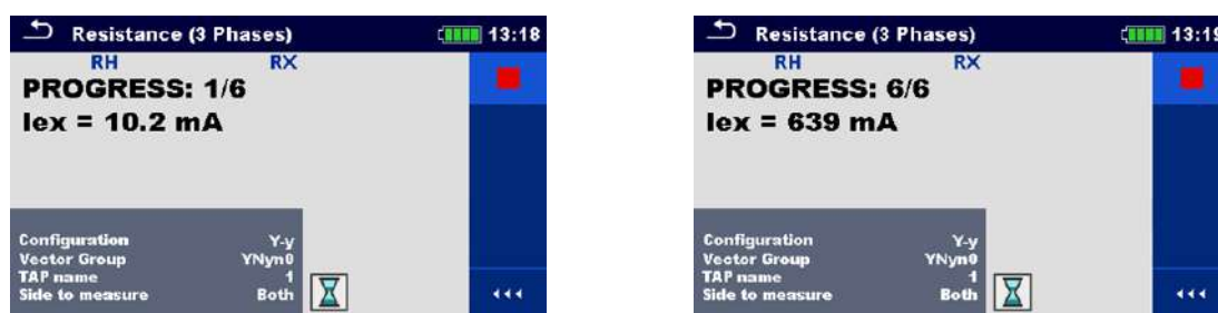
Figura 11.21: El indicador de progreso en la medición de resistencia del bobinado del transformador trifásico: primero (1/6) prueba en curso (izquierda) y último (6/6) prueba en curso (derecha)
