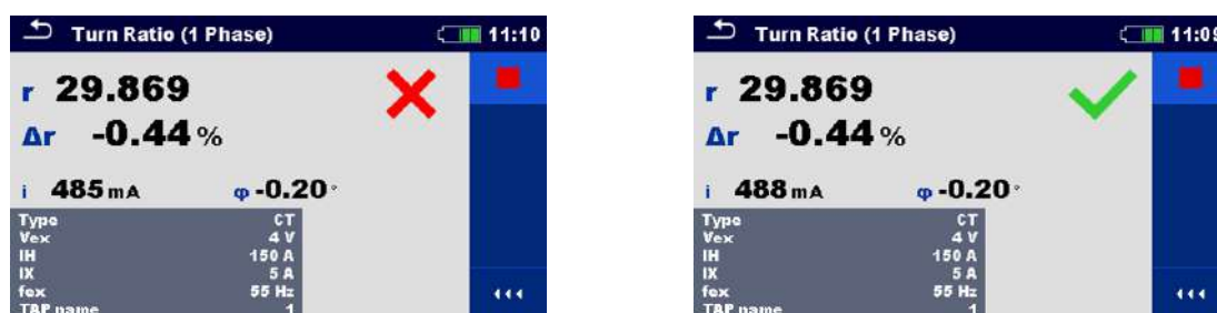
Figura 11.12: Resultados de medición del ratio de espiras de un transformador TC monofásico:
